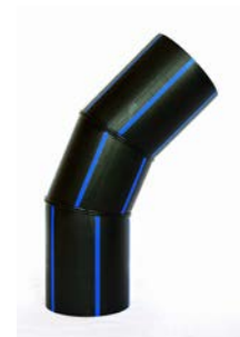
Łuk segmentowy 31-60° PE 100 SDR 17 Wykonanie wg PN-EN 12201-3
