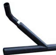
Trójnik segmentowy kątowy 45° z łukiem 60° PE 100 SDR 17 Wykonanie wg PN-EN 12201-3:2012
