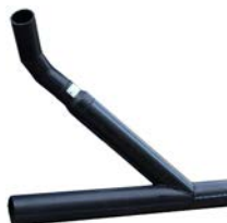
Trójnik segmentowy kątowy 45° z łukiem 60° PE 100 SDR 11 Wykonanie wg PN-EN 12201-3
