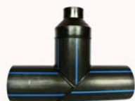
Trójnik segmentowy 90° redukcyjny PE 100 SDR 17 Wykonanie wg PN-EN 12201-3
