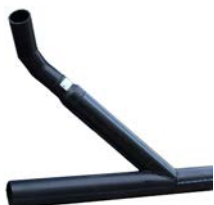
Trójnik segmentowy kątowy 45° z łukiem 60° PE 100 SDR 11 Wykonanie wg PN-EN 12201-3
