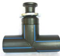
Trójnik segmentowy 90° kołnierzowy PE 100 SDR 17 Wykonanie wg PN-EN 12201-3:2012
